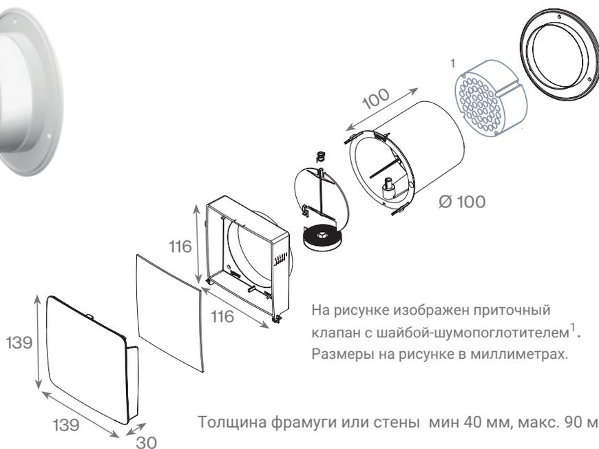
На рисунке изображен приточный клапан с шайбой-шумопоглотителем<sup>1</sup>. Размеры на рисунке в миллиметрах.
